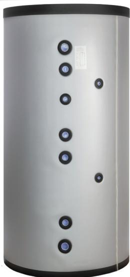
La serie de acumuladores ROBC fue diseñada para obtener una gran producción de agua caliente sanitaria, a través de su acumulación con aplicación de un posible intercambiador de placas externo. La larga duración del depósito está asegurada por el tratamiento interno de vitrificación, realizado a casi 850°C según la normativa DIN-4753 y del ánodo de magnesio anticorrosión.
