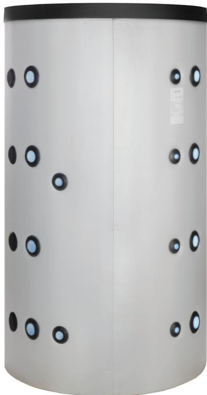
La serie de acumuladores PSW2 son depósitos de inercia para la producción y acumulación de agua técnica o de calefacción con un serpentín fijo dedicado al solar térmico y otro para una fuente auxiliar de postcalentamiento. Este acumulador es usado donde se necesita incrementar la inercia térmica de la instalación.
