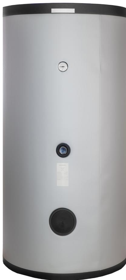
La serie de interacumuladores RBC fue diseñada con una gran superficie de intercambio con un intercambiador fijo vitrificado para obtener una gran producción de agua caliente sanitaria. La larga duración del depósito está asegurada por el tratamiento interno de vitrificación, realizado a casi 850°C según la normativa DIN-4753 y del ánodo de magnesio anticorrosión.
