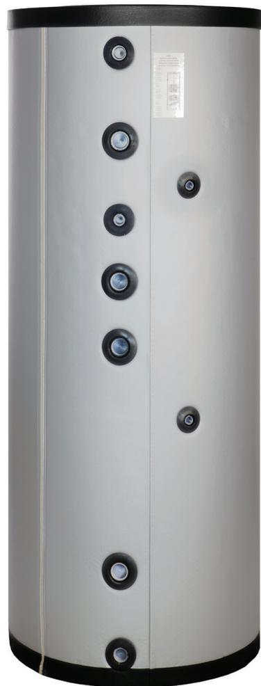
La serie de interacumuladores R2BC fue diseñada con una gran superficie de intercambio con un doble intercambiador fijo vitrificado una gran producción de agua caliente sanitaria. La larga duración del depósito está asegurada por el tratamiento interno de vitrificación, realizado a casi 850°C según la normativa DIN-4753 y del ánodo de magnesio anticorrosión.
